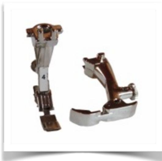
Il ressemble à un petit surf, et n'oubliez pas de décaler votre aiguille, si vous essayez de coudre avec l'aiguille en position centrale vous allez la briser sur le pied. Ce pied est très pratique car lorsque l'on coud il peut se guider avec le bord du pied contre la fermeture éclair.
